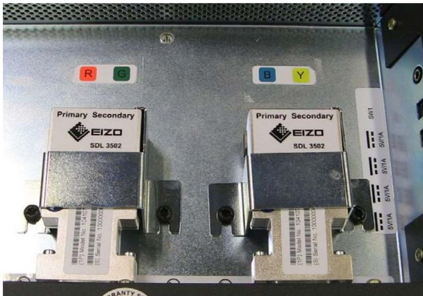
5. Verbinden Sie die CAT-Kabel mit den Anschlüssen der DVI-Empfängermodule und ziehen Sie die Schellen fest. Beachten Sie beim Stecken der Kabel die Farbkodierung und die kundenspezifischen Hinweise.
